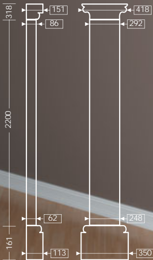
ВхГхШ 2679х151х418 габариты конструкции в мм.
